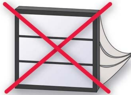
Falsche Montage – Liegend (Hygiene und Druckverlust)
